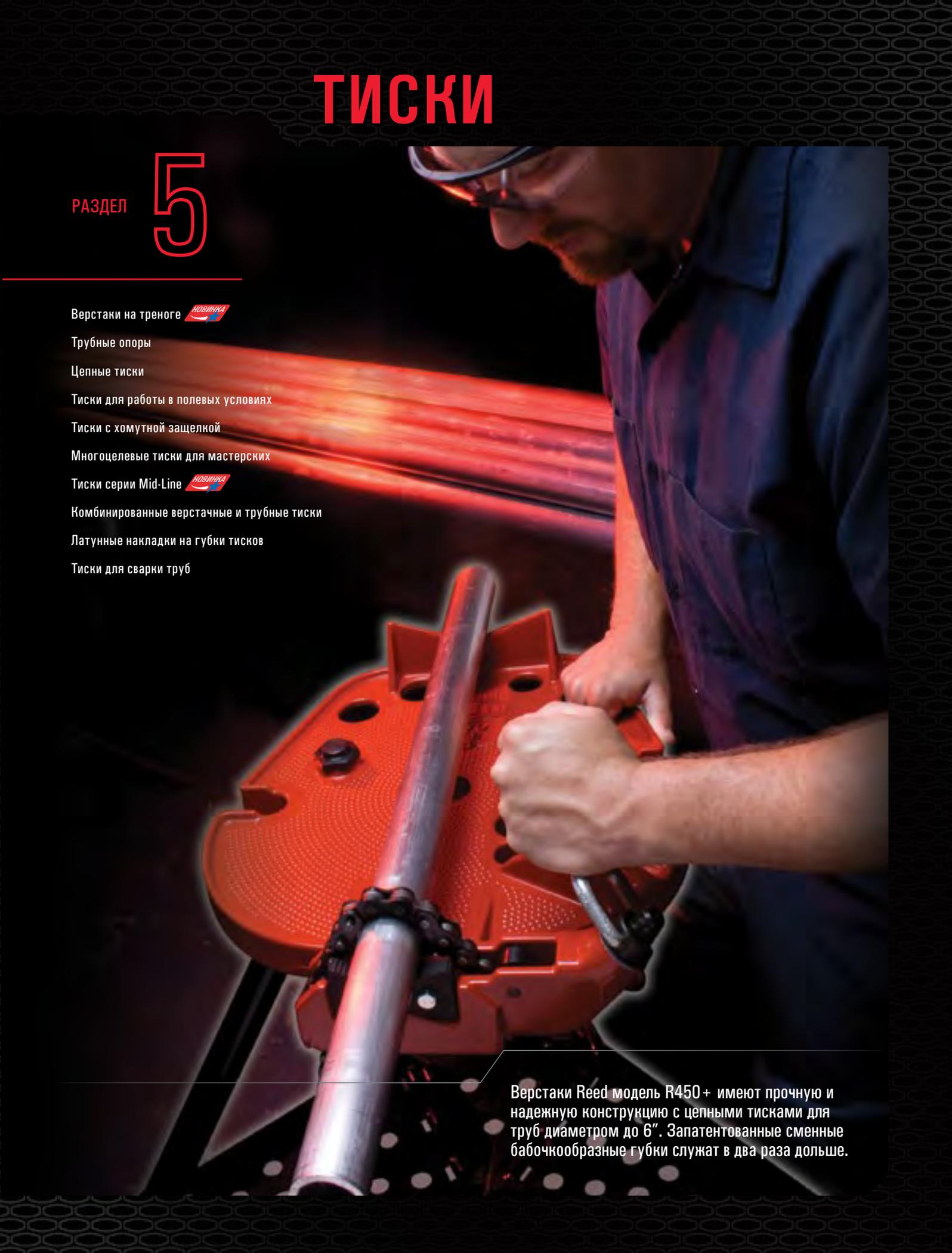
Верстаки Reed модель R450+ имеют прочную и надежную конструкцию с цепными тисками для труб диаметром до 6". Запатентованные сменные бабочкообразные губки служат в два раза дольше.
